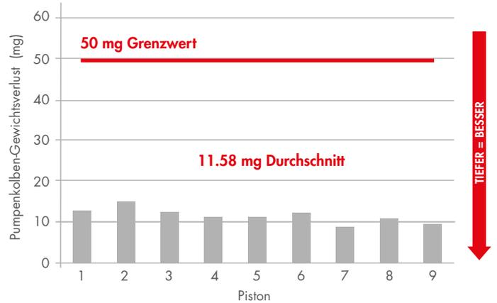
Bosch Rexroth RFT-APU-CL Prüfstandtest
