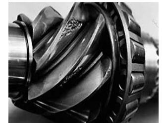
Grobe Pitting-Bildung auf der Flanke des Ritzels eines Hypoidgetriebes.
