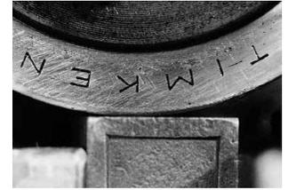
Reibstelle Prüfring-Block der TIMKEN-Prüfmaschine
