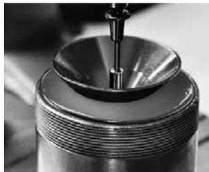
Penetrometer. Der Kegel des Prüfgerätes ist in das Fett eingedrungen.
