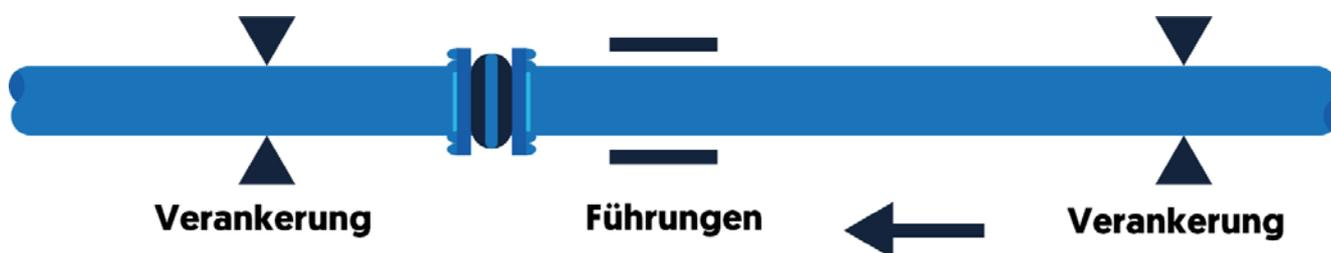
Jeder Kompensator übt Kräfte auf ein Rohrleitungssystem oder eine Verbindung aus. Achten Sie daher auf mögliche Komplikationen.
