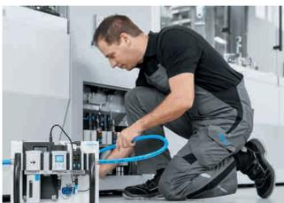
Bei der Messung des exakten Druckluftverbrauchs an einzelnen Maschinen im Stillstand und im laufenden Betrieb analysieren unsere Mitarbeiter verschiedene Kenngrößen wie den Verbrauch pro Maschinenzyklus, den Durchschnittsverbrauch pro Minute, den Durchschnittsdruck, den Druck max./min. und den Luftvolumenstrom max./min. Diese Messergebnisse werden in einem Bericht dokumentiert.
