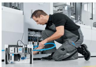
En mesurant la consommation exacte d'air comprimé sur les machines (en fonctionnement et pendant les phases d'arrêt), notre équipe analyse différentes caractéristiques comme la consommation par cycle machine, la consommation moyenne par minute, la pression moyenne, la pression min./max., le débit min./max. Tous ces résultats sont documentés dans un rapport.
