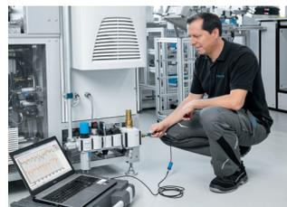
Les chutes de pression dans le système peuvent être enregistrées en utilisant plusieurs capteurs de pression avec des enregistreurs de données installés à différents endroits dans le système d'air comprimé. En réduisant la pression, des économies d'énergie pouvant aller jusqu'à 8% pour la génération de pression peuvent être obtenues.
