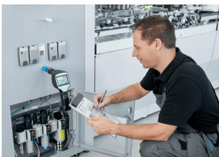
L'huile, l'eau ou les poussières dans l'air comprimé ont un effet négatif sur la durée de vie des composants pneumatiques. Les coûts énergétiques et de fonctionnement augmentent ; dans le pire des scénarios, cela peut amener à des arrêts imprévus de la production. La mesure centralisée et décentralisée de la qualité de l'air comprimé inclut l'inspection des traitements d'air, des mesures de points de rosée, de teneur en huile, de température et de pression.
