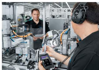
Une gestion optimale des fuites diminue radicalement le coût de l'air comprimé, car les composants comportant des fuites sont un gouffre en énergie comme en argent. Nos spécialistes vérifient le réseau d'air comprimé complet, depuis les compresseurs jusqu'aux applications pneumatiques.
