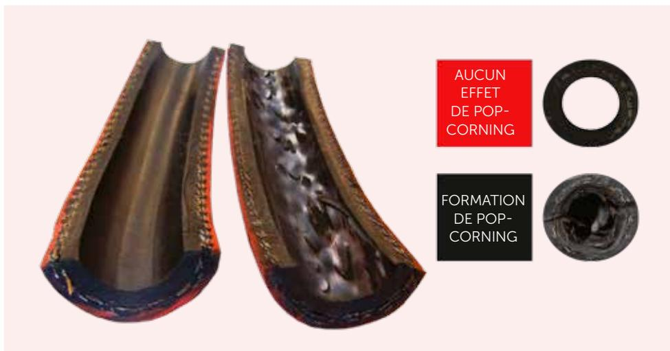
Pour la paroi interne du flexible vapeur, Goodall® a mis au point un composant en caoutchouc non poreux.
