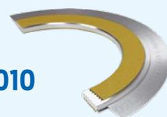
Les joints striés avec un anneau rainuré et un revêtement en matériau tendre se caractérisent par une faible pression superficielle minimale. La valeur de la pression superficielle maximale admissible est très élevée. Cela permet une large gamme d'applications : plage de température allant jusqu'à 1 000 °C et conditions de haute pression.
