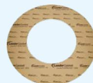
Cette plaque d'étanchéité en fibre est fabriquée à partir de phlogopite modifié avec un insert métallique résistant aux acides en acier au chrome-nickel. Les plaques sont faciles à manipuler et à découper. Elles peuvent être utilisées comme joints plats à des températures allant jusqu'à 1 000 °C.
