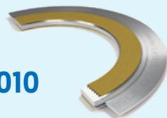
Kammprofildichtungen mit einem gerillten Kammprofil-Trägerring und einer Weichstoffauflage, zeichnen sich durch eine tiefe Mindestflächenpressung aus. Der Wert der maximal zulässigen Flächenpressung ist sehr hoch. Dies erlaubt einen breiten Anwendungsbereich: Temperaturbereich bis 1000 °C und bei hohen Druckverhältnissen.
